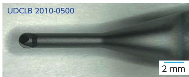
・有効長5 mmの加工 体積 131.9 mm<sup>3</sup> 時間 76.5 min
