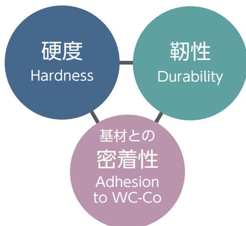
超硬合金・硬脆材加工用に高性能特殊ダイヤモンド皮膜を開発。
