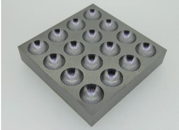
レンズ型加工 Lens shaped milling
